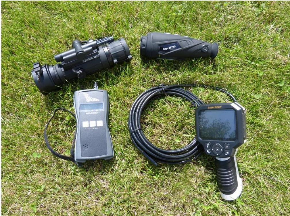
Bild 20: Endoskopkamera, Batdetektor, Nachtsichtgerät und Wärmebildkamera für Fledermausuntersuchung
