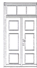
Abb. 1: Hauseingangstür, stehendes Format, 2-flügelig mit Oberlicht
