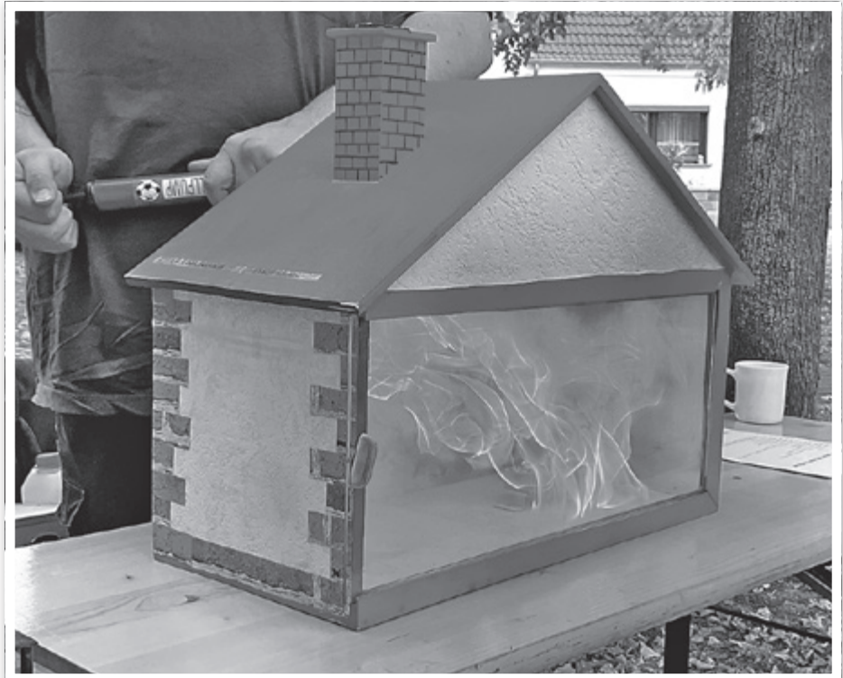
Station Brandschutzerziehung – Staubexplosion im Brandhaus
