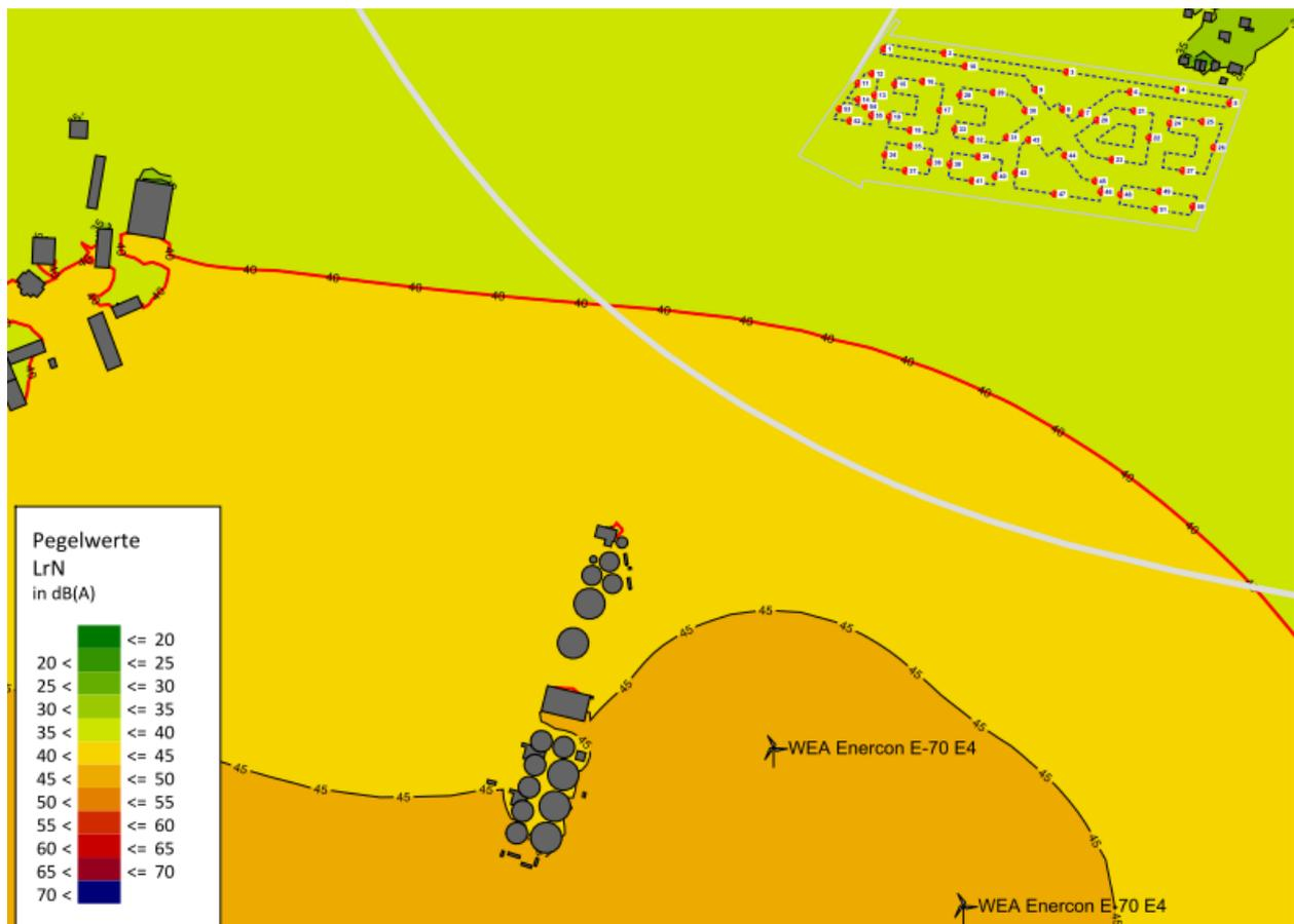
Bild 6 | Windkraftanlagen Beurteilungspegel Nacht
