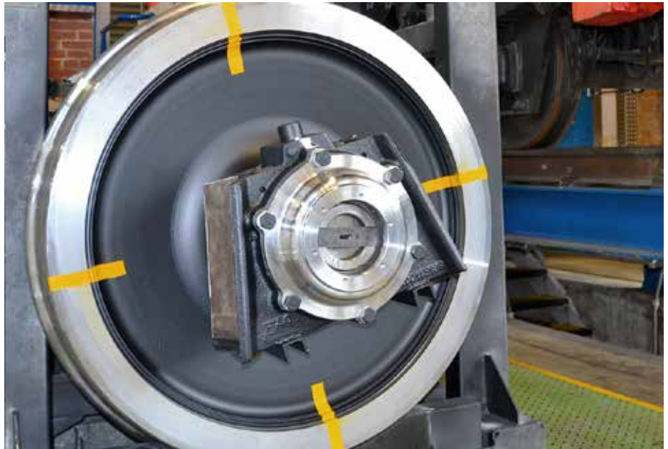
Printed in Berlin-Marzahn: ein so genannter Radsatzlagerdeckel aus Metall (Radmitte)
