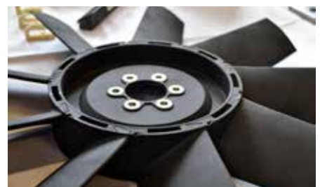
Kommt ebenso aus einem 3D-Drucker: ein Lüfterrad für einen Triebwagen
