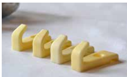
Mit Kunststoffhaken für ICE-Züge aus dem 3D-Drucker fing alles an.
